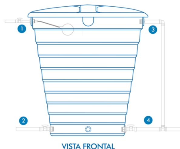
1. **Tubo de entrada:** para armazenamento da água no reservatório; 2. **Tubo de saída:** para distribuição da água nos pontos de consumo; 3. **Tubo extravasor ou ladrão:** para escoamento de eventual excesso de água; 4. **Tubo de limpeza:** para escoamento da água após a limpeza do reservatório
